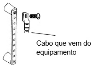
conector no barramento do quadro de distribuição
