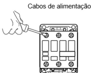
Solte os 02 parafusos do contator
