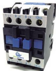
A chave contatora é um dispositivo eletromecânico que permite, a partir de um circuito de comando, efetuar o controle de cargas num circuito de potência. Essas cargas podem ser de qualquer tipo, de tensão diferente do circuito de comando, e até conter múltiplas fases.
