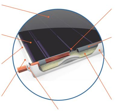
Anéis de vedação entre os tubos e a caixa em EDPD que preservam a estanqueidade do coletor. Aletas com contato em perfil ômega com tubo de elevação conferem maior transmissão termica de calor para a água.
