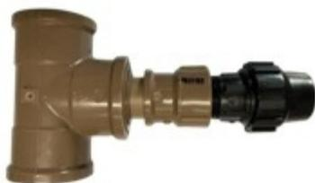
A transição para a tubulação de alimentação do coletor é realizada através de uma transição fêmea com tubo de 32mm soldável e tê de PVC marrom, conforme tubulação (diâmetro determinado pelo dimensionamento, página 08).
