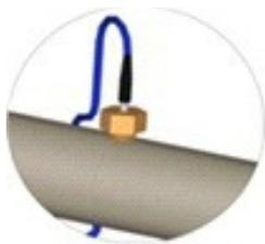
Na tubulação de retorno, após o conjunto de coletores, é aplicado o porta sensor feito de latão, com uma rosca de 9 ou 10 mm para ser rosqueado no próprio tubo de PVC marrom, alocando o sensor posteriormente.
