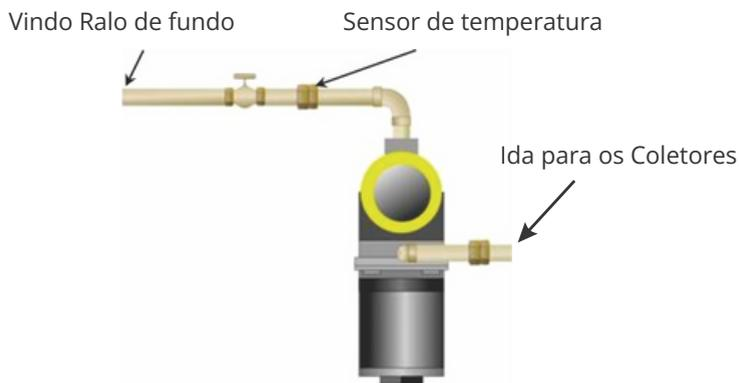
Na tubulação de sucção, após o registro e antes de chegar na bomba, é aplicado o porta sensor feito de latão, com uma rosca de 9 ou 10 mm para ser rosqueado no próprio tubo de PVC marrom, alocando o sensor posteriormente.
