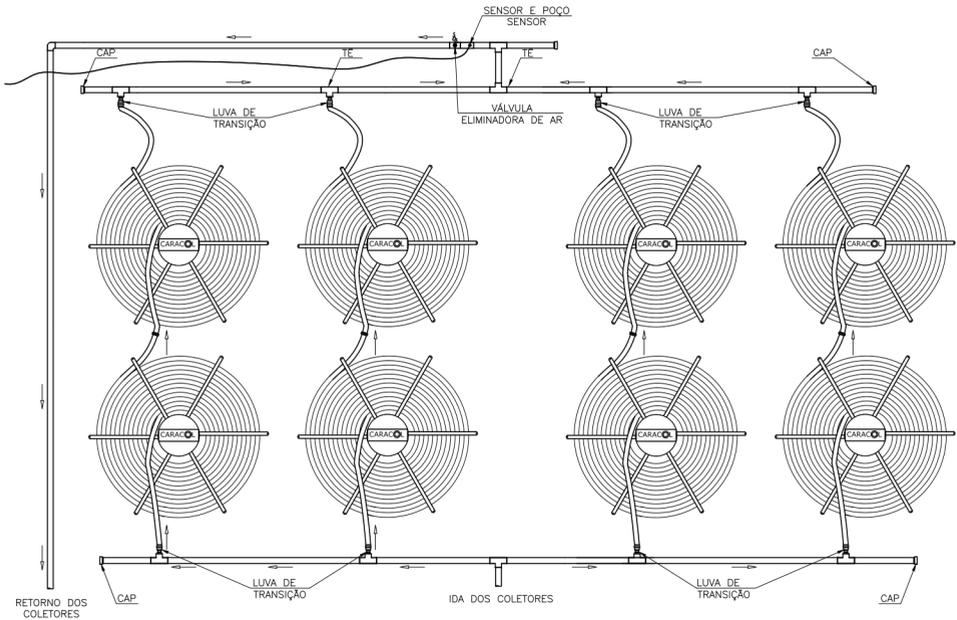
Para os modelos CA14 e CA17, cada coletor deverá ser ligado tanto na rede alimentação de água (com o tubo interno do círculo) e na rede de retorno de água quente para a piscina (com o tubo externo do círculo). Veja o esquema a seguir:
